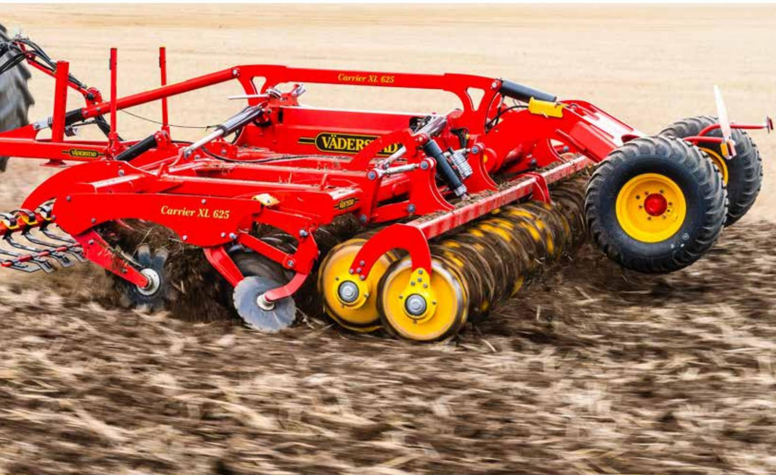
Carrier XL 425-625 може да бъде оборудван с дискове, с регулируем работен ъгъл с размер от 510 или 610 mm.
