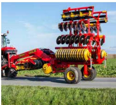
За да се осигури лесен и безопасен транспорт, Carrier 420-820 се свърва до 2,5 метра транспортна ширина.
